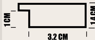
SEZIONE CORNICE SCALA 1:1
